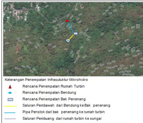
Gambar 4.2 Lokasi Penempatan Infrastruktur Mikrohidro sesuai Peta Topografi
